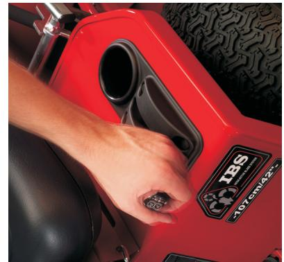
A COUNTAX kézifék egy fontos biztonsági eszköz, mely behúzott álaponban megalakította, hogy a traktor meginduljon. Az OMS fedélzeti vezérő rendszer figyelmezteti a kézifék behúzott állapotára.
